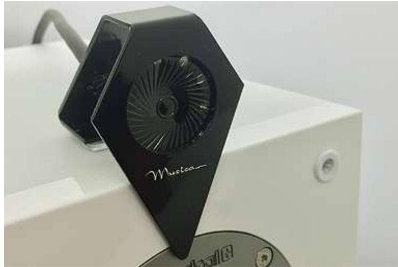
スーパーツイーターを設置するとき、メインスピーカーの振動板とスーパーツイーターの振動板との前後の位置を一致させることは重要です。音は1秒間に340.3m伝わります。振動板の位置が僅か10cmずれただけでも音は1/3403秒遅れてしまいます。本機は振動板の位置をミリ単位で調整することが可能とし、位相特性を7完全に一致させることが可能です。本機はカットオフ周波数10KHzのネットワーク内蔵しています。
