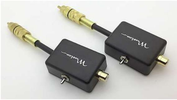
低域増強アダプターは低音量を電氣的に増加させるものではありません。中高音の音量を低下させることによって低域のみが保持され、結果として低域が増強されたように感じます。この方式は音楽の平均音量は下りますが電源は不要で音の鮮度が落ちません。プリアンプとパワーアンプ間やCDプレーヤーとプリメインアンプ間に挿入して使用します。低域増強量は3ポジションのスイッチで調整することができます。
